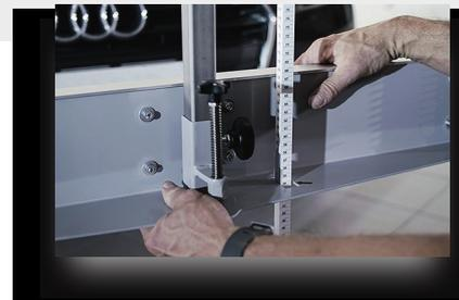
Εξοπλισμένο με ειδική χειρολαβή για αποτελεσματικούς χειρισμούς ευθυγράμμισης κατασκευής με όχημα.
