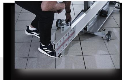
Μηχανισμός σταθεροποίησης στην τροχήλατη βάση της κατασκευής
