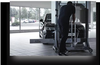
Ακριβής ρύθμιση καθ' ύψος βάσης στήριξης πινακιδίων στόχευσης, εύκολος χειρισμός με απελευθέρωση ελατηρίου κλίμακας για επίτευξη ρύθμισης σύμφωνα με τις οδηγίες του κάθε κατασκευαστή (1.85 m για μικρά φορτηγά)
